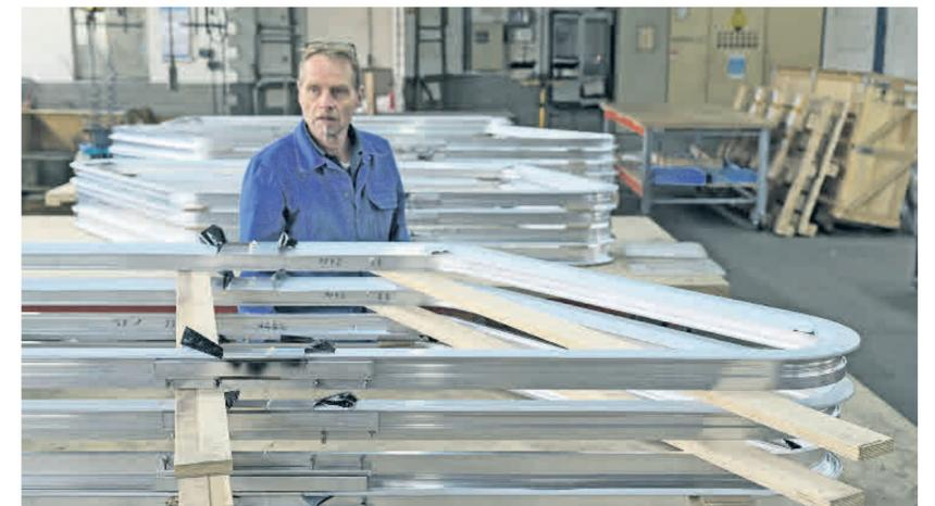
**Rahmenwerk:** Weil ein Schiff sich massiv bewegt, muss der Rahmen verschiedene Belastungen aushalten, druckwasserdicht sein und zugleich das spröde Glas schützen.
