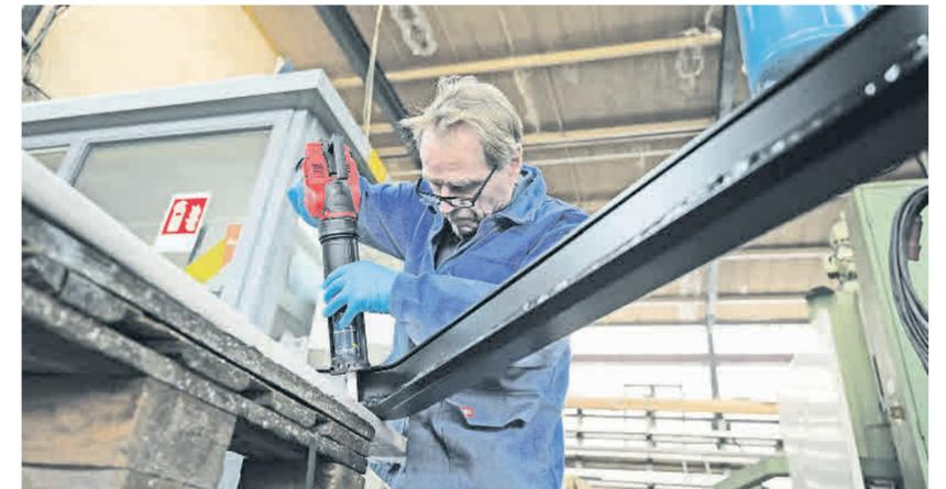
**Viel Handarbeit:** Bei der Montage werden die hochfesten Scheiben kalt mit einer Halterung eingeklemmt, ohne Schweißverbindung oder Verschraubung. Umso besser müssen die Spalte abgedichtet werden.
